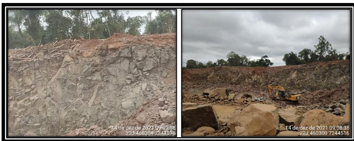
Figura 56 – Exemplo de extração de basalto para beneficiamento e uso na obra da PCH.
