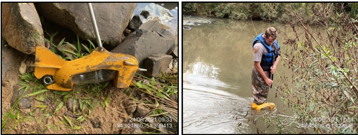
Figura 40 – Amostrador de sólidos em suspensão (DH-48).
