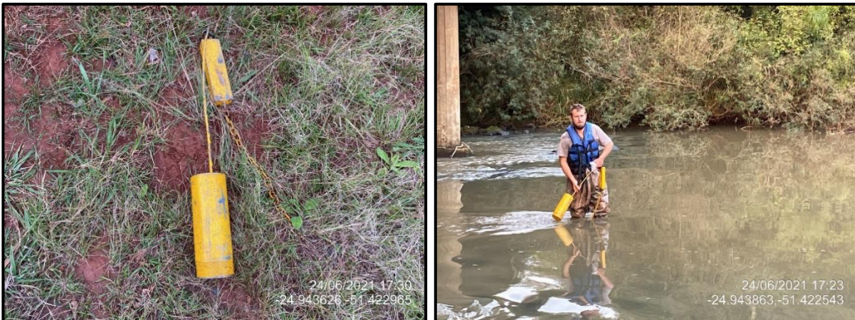
Figura 42 – Amostrador AMF-2 adaptado.
