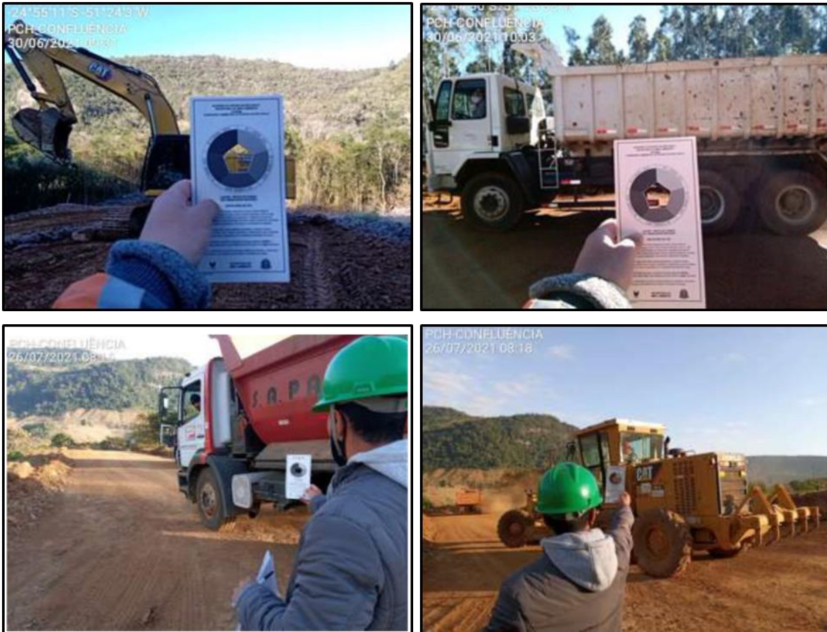
Figura 260 - Execução do teste de fumaça preta utilizando a escala Ringelmann durante o primeiro semestre de implantação da PCH Confluência.
