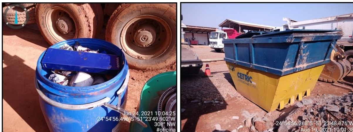
Figura 232 - Exemplo de bombona e caçamba para depósito temporário de resíduos classe I da PCH Confluência.
