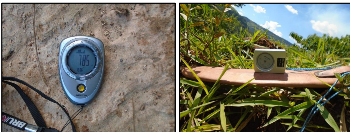
Figura 5 - Avaliação da altitude com altímetro (à esquerda) e declividade com o clinômetro (à direita).
