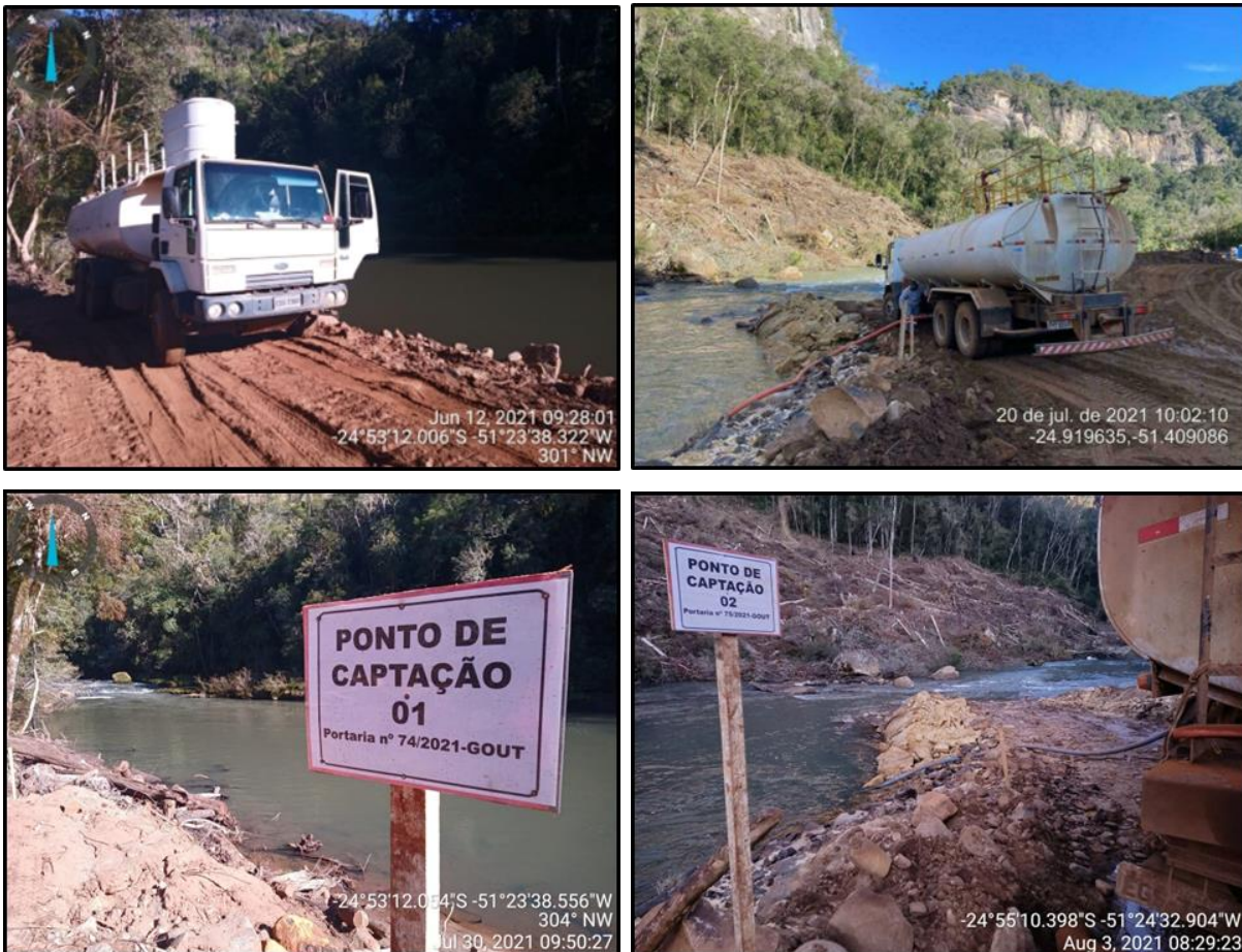
Figura 258 - Pontos outorgados de captação de água superficial no rio Marrecas por caminhão pipa com capacidade de 20 m 3 .
