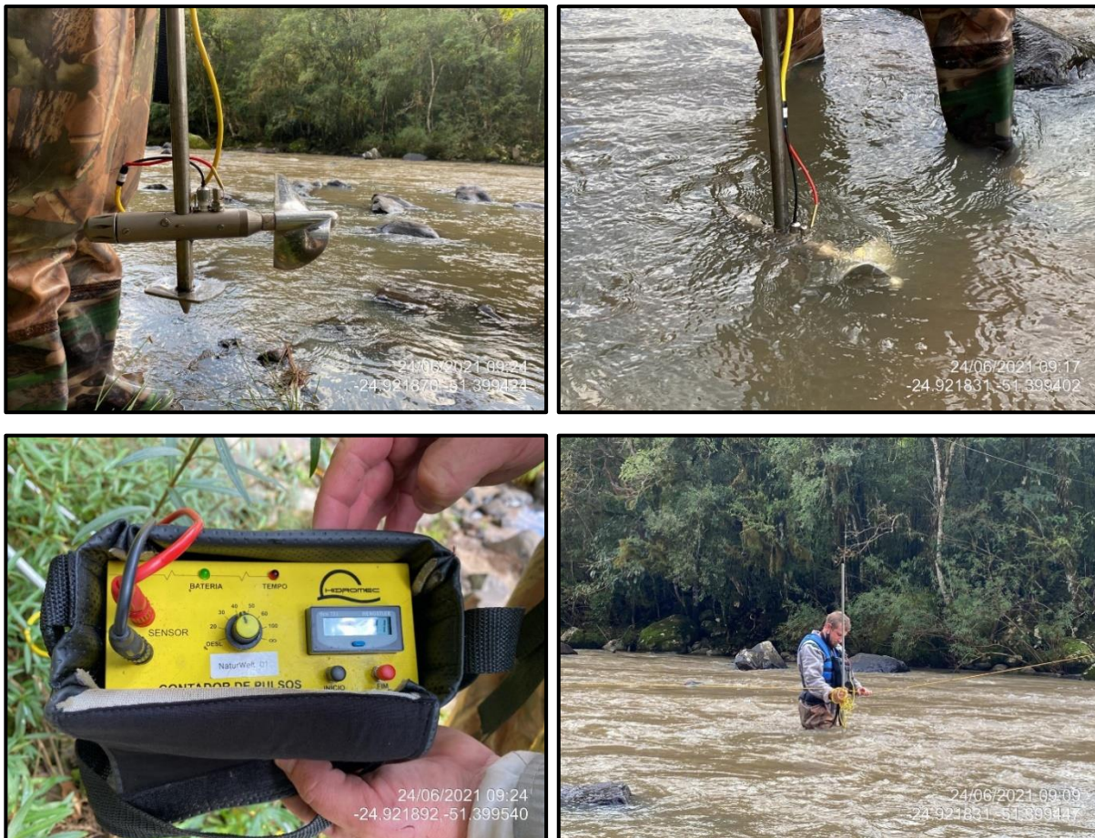
Figura 39 – Molinete hidrométrico e contador de pulsos.
