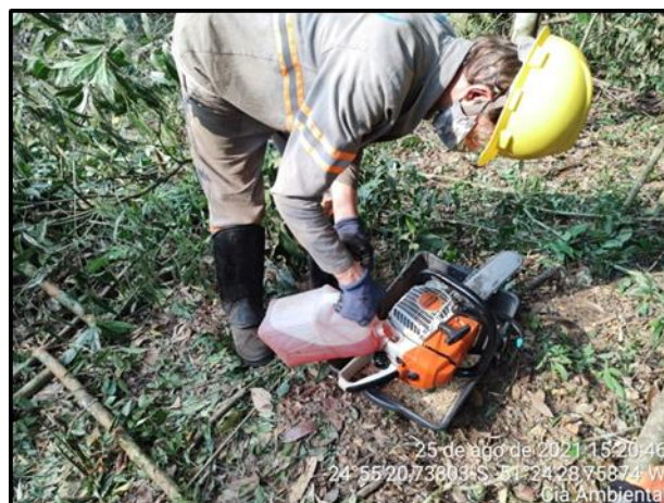
Figura 242 - Abastecimento em campo de motosserra utilizando sistema de contenção contra possíveis vazamentos.
