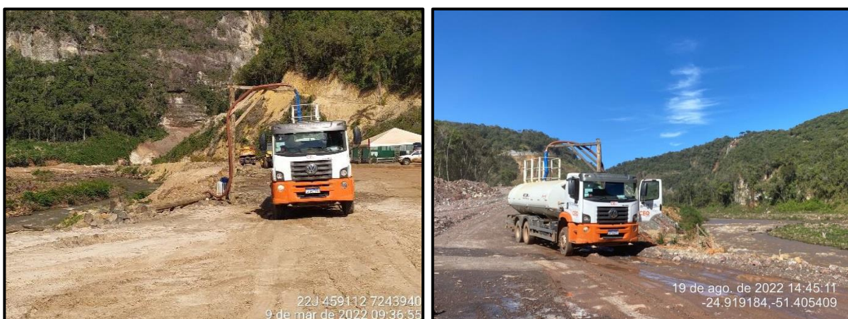
Figura 180 - Pontos outorgados de captação de água superficial no rio Marrecas por caminhão pipa com capacidade de 20 m 3 .
