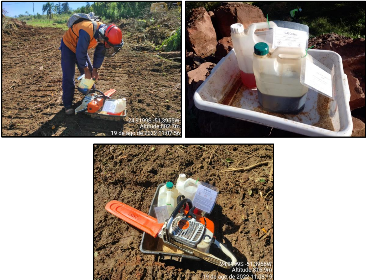
Figura 175 - Abastecimento em campo de motosserra utilizando sistema de contenção contra possíveis vazamentos.
