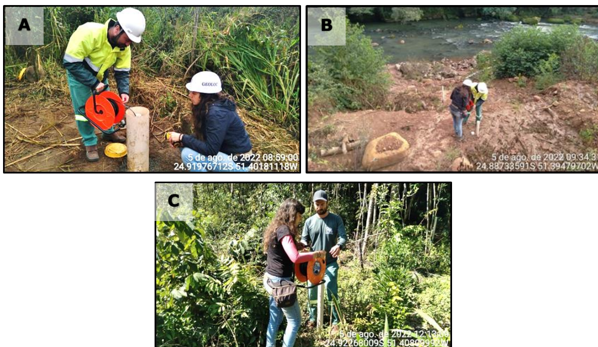
Figura 24 - Medição de níveis d'água nos MNAs presentes na PCH Confluência, após as atividades de manutenção e limpeza.
