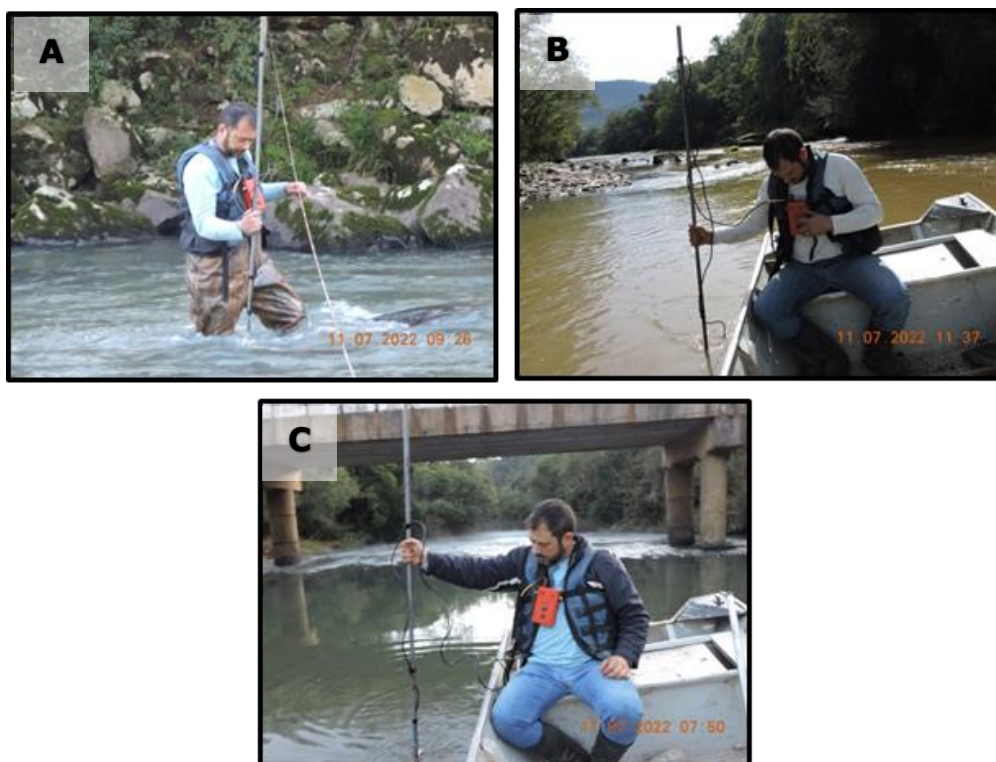
Figura 27 - Medição de vazão realizada em 11 de julho de 2022 na seção montante (A), jusante (B) do rio Marrecas e na seção montante do Rio Cachoeira (C) da PCH Confluência, Turvo (PR).
