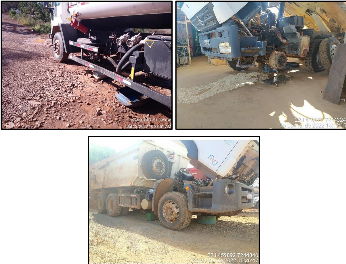
Figura 172 - Exemplos de utilização de bacias de contenção como método preventivo contra vazamentos de óleo na oficina da PCH Confluência.
