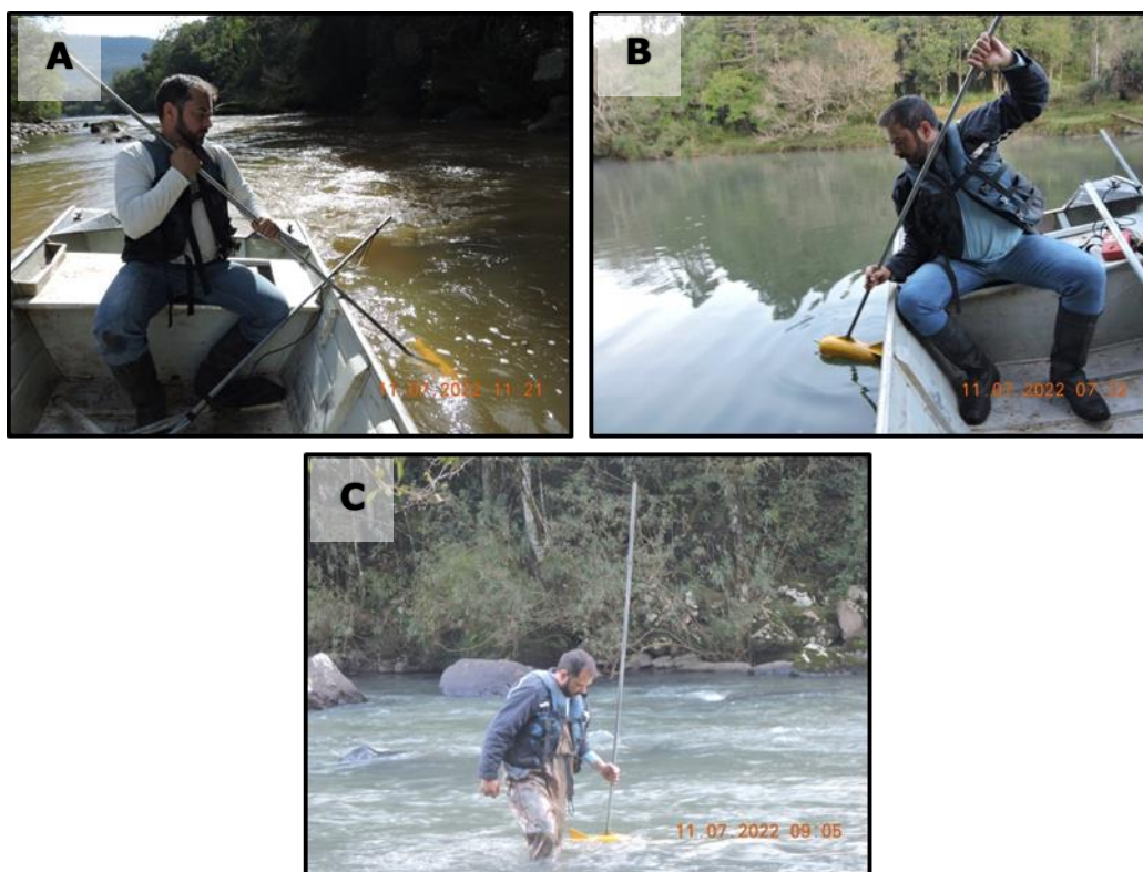
Figura 28 - Coleta de amostras de sedimentos em suspensão no dia 11 de julho de 2022 na seção montante (A), jusante (B) do rio Marrecas e na seção montante do Rio Cachoeira (C) da PCH Confluência, Turvo (PR).
